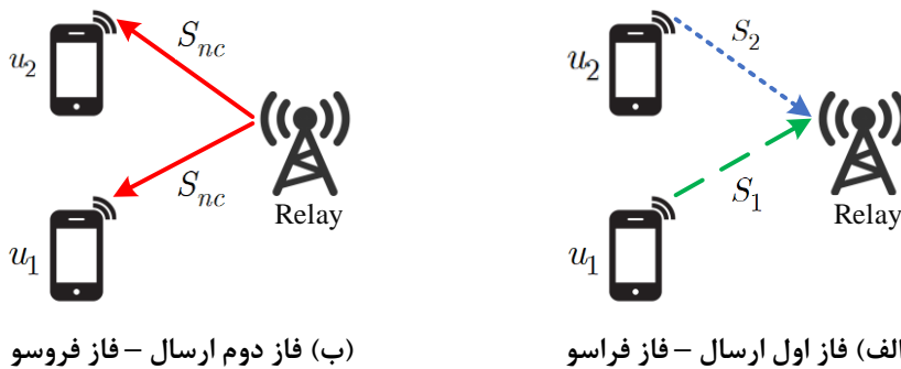
شکل (۱) فازهای مختلف ارسال در شبکه رله دوطرفه با کدگذاری شبکه
